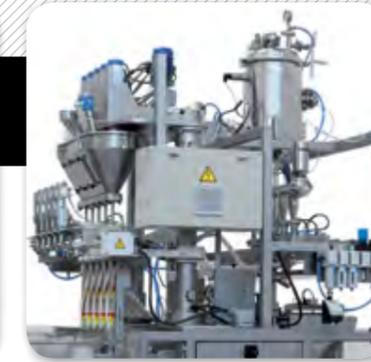
2. Pulver- und Flüssigkeitseinfüllung.
